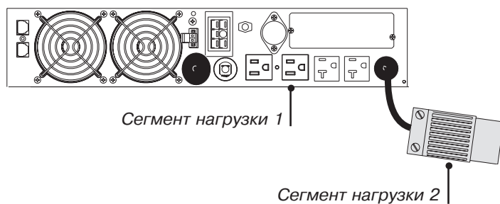
Рисунок 36. Сегменты нагрузки ИБП для моделей 120В
